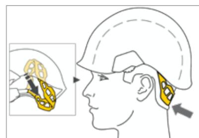
Avec le système **FLIP&FIT**, le bandeau peut être placé en position basse pour assurer un soutien optimal du casque. Lorsque le casque n'est pas utilisé, le système peut être rangé dans la coque du casque.
