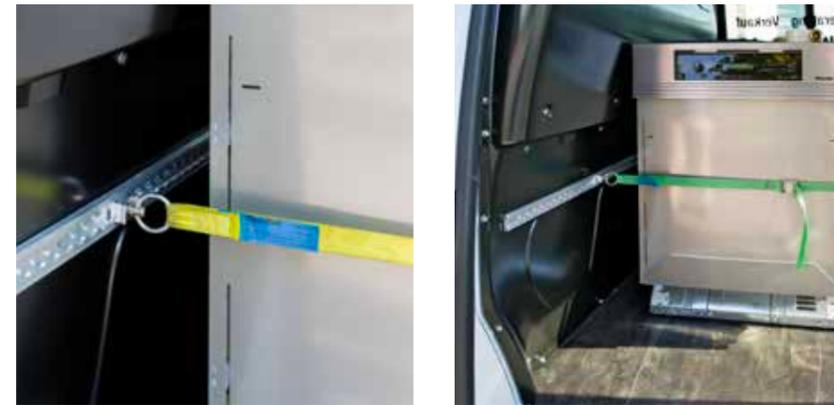
**Arrimage intérieur de 25 mm de type AK10-I avec boucle de serrage rapide galvanisée (01155) et avec raccord spécial cousu pour rail d'ancrage (71105) de type «single stud fitting» avec anneau de Ø 28 mm. Sangle en 100% polyester, jaune.**
