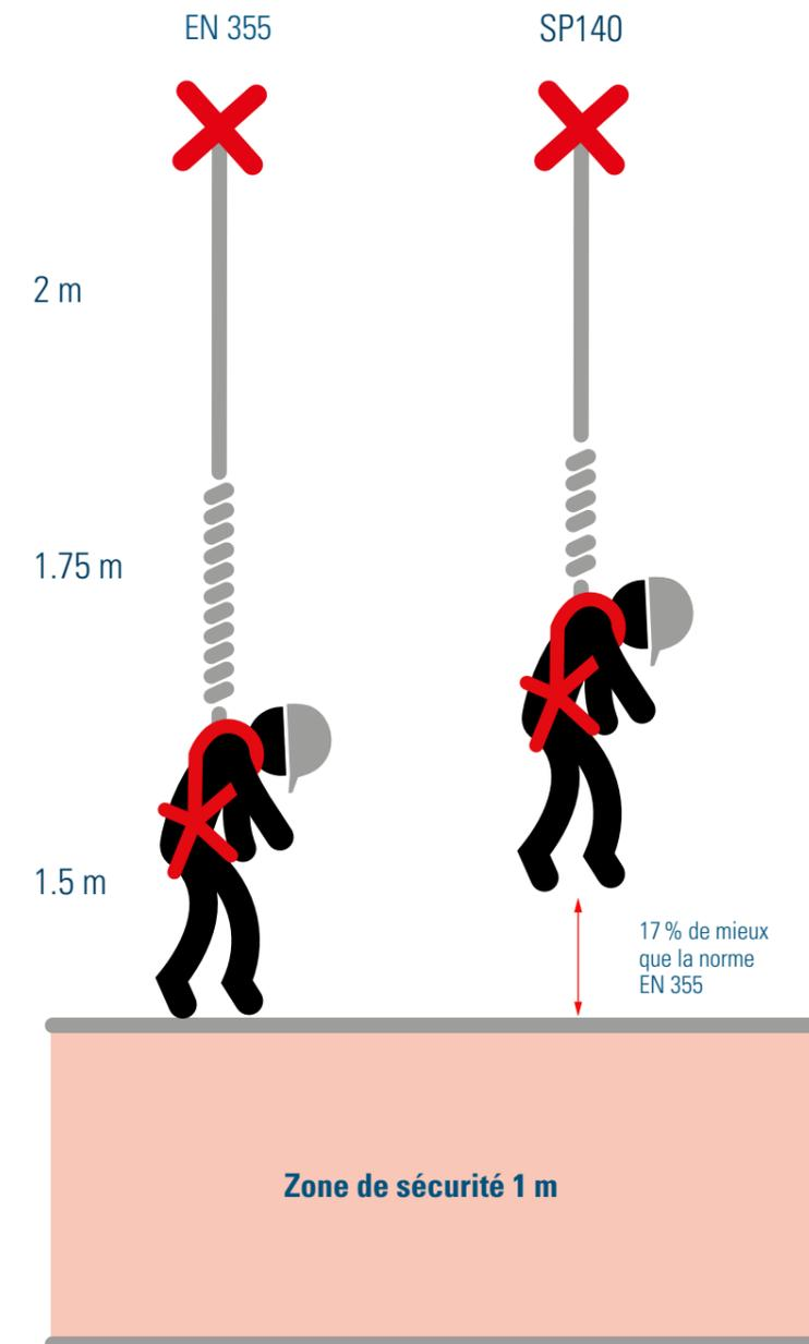
Le système de retenue doit retenir l'accidenté de manière contrôlée et freiner l'énergie de la chute pour préserver la personne.
