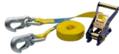
**Sangle d'arrimage 25 mm avec tendeur à cliquet** (EN12195-2) en acier promatisé à haute résistance, recouvert de résine époxy bleue (20015). Sangle jaune 100% polyester, 25 mm de large, thermofixée, à faible allongement. Mousquetons à triangle avec linguets.
