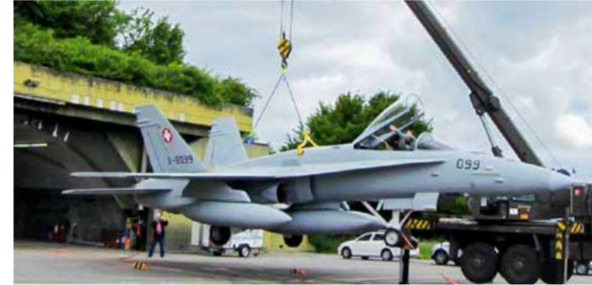
**Jeu de levage GrabiQ à 4 brins** (EN 818-4) avec maille d'accouplement à raccourcisseur intégré et crochet de sécurité GBK ou crochet EGKN avec linguet
