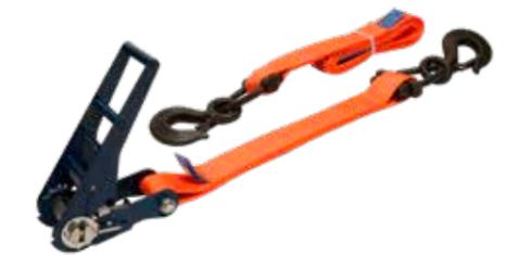
**Sangle d'arrimage 75 mm type ABS100, tendeur à cliquet** (EN12195-2) en acier à haute résistance, galvanisé et revêtu de résine bleue, détente contrôlée dent par dent (20040). Sangle en 100% polyester, 75 mm de large, orange, thermofixée à allongement faible. Robuste et idéale pour l'arrimage diagonal.
