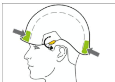
Le système de réglage **CENTERFIT**, avec ses deux roues de réglage latérales, assure que le casque reste centré sur la tête.
