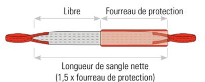
Lors de la mise en place / du retournement avec NoCut®sleeve, utilisez un chevauchement d'au moins + 20% de la longueur du fourreau de protection.
