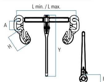
Tendeur à cliquet avec crochets parallèles avec sécurité (EN 12195-3)
