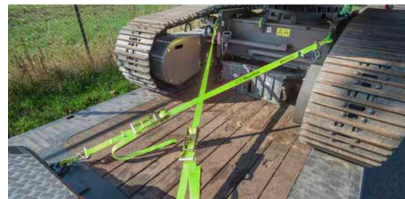
**Sangle d'arrimage 55 mm, type MX (une seule pièce) avec tendeur** en acier à haute résistance, promatisé. Sangle en fibre de haute performance de 55 mm de large, verte, thermofixée à allongement très faible. Renforcement de la puissance grâce au principe du système Carlash. Avec crochets triangulaires ExoSet (LS). Idéale pour l'arrimage diagonal, robuste et pratique.
