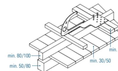
**Point d'ancrage de toit (EN 795 type A)**
