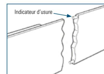
Le HSL a un indicateur d'usure intégré. Cela permet à l'utilisateur d'évaluer l'état de la sangle horizontale. Si le fil de contrôle noir est exposé, le HSL ne peut plus être utilisé.
