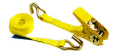
**Sangle d'arrimage de 25 mm type 01802-609 avec cliquet** (EN12195-2) galvanisé et thermolaquée en jaune (20004GE). Sangle en 100% polyester, 25 mm de large, rouge, thermofixée à allongement faible. La sangle d'arrimage légère et pratique pour les petites charges, avec mousquetons à triangle.
