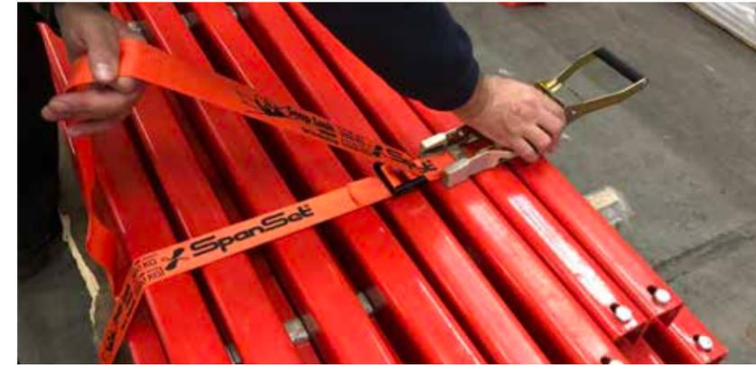
Pour l'expédition individuelle de marchandise, la sangle et la boucle s'en vont, le tendeur reste. Force de rupture de 4t en cerclage.
