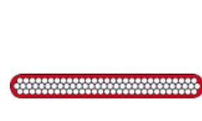
Fig.1: enduit polyuréthane contre l'usure
